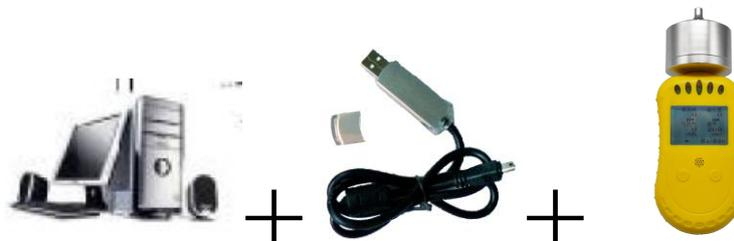
接法：数据线 USB 接到计算机的 USB，Micro USB 接仪器。
