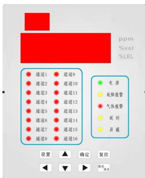
图 7 控制面板示意图
